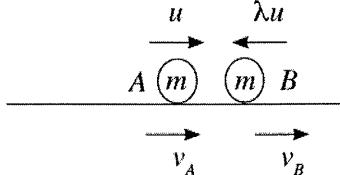
$$(mv_A + mv_B) - (mu - m\lambda u) = 0 \\ \therefore v_A + v_B = (1 - \lambda)u \quad \text{--- (1)} \quad (10)$$
